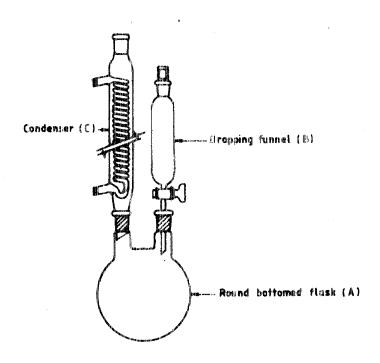
Fig. 1 - Decomposition apparatus
